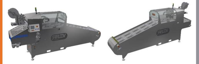
Macchina automatica per applicare una fascia di nastro adesivo attorno a vari prodotti sfusi, anche delicati. I prodotti vengono caricati manualmente su appositi alloggiamenti detti "culle"; queste sono montate su una coppia di catene che avanzano simultaneamente. Gli operatori addetti al carico possono essere posizionati sia nel retro della macchina che su entrambi i lati. Il prodotto viene trasportato verso la stazione di nastratura e successivamente evacuato su un nastro morbido.
