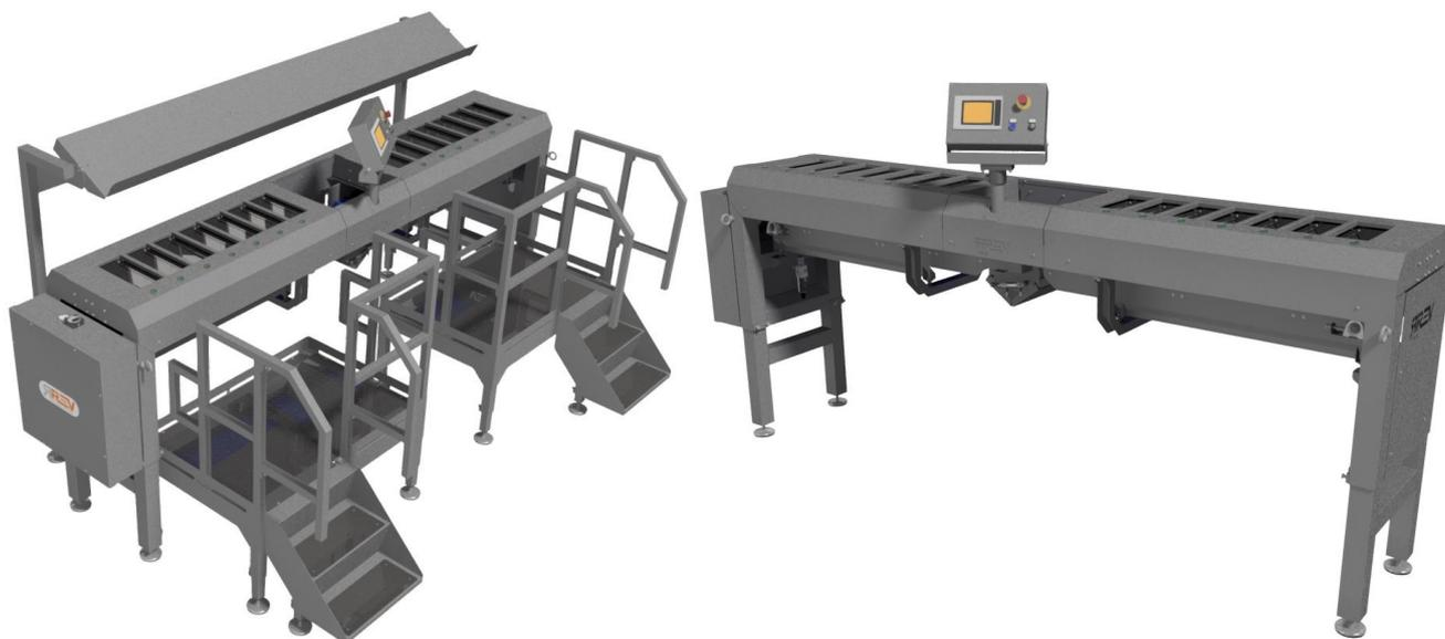
**Thor** è una pesatrice combinatoria a caricamento manuale, adatta alla preparazione di dosi secondo un peso prestabilito (e mai inferiore). I prodotti vengono posizionati dagli operatori direttamente sulle bilance/tramogge, dopodiché la macchina calcola la migliore combinazione possibile e compone la dose. I prodotti cadono su due nastri a onde morbide e vengono evacuati su una tramoggia centrale.
